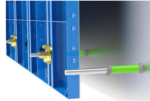
El uso de **CONOS PLASTICOS** y separadores PVC permiten generar el espesor exacto que requiere el muro, además de aislar completamente la varilla diwidag del concreto y así tener un rápido y sencillo desencofre de las varillas roscadas.
